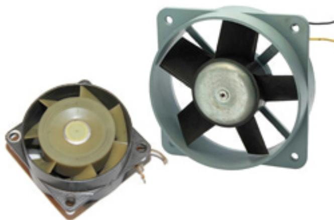
**Вентиляторы ВВФ-112, ВВФ-112М, ВВФ-71М** – терморегулирующие устройства, обеспечивающие оптимальный температурный режим компьютерной и другой электроприводной техники. Вентиляторы серии **ВВФ-112** рассчитаны на питание от автономного источника питания с постоянным напряжением **12В**, вентиляторы серий **ВВФ-112М, ВВФ-71М** – от сети переменного тока частотой 50Гц и напряжение **220В**, потребляемый ток при этом не превышает **600mA**, а потребляемая мощность – не более **22Вт**.
