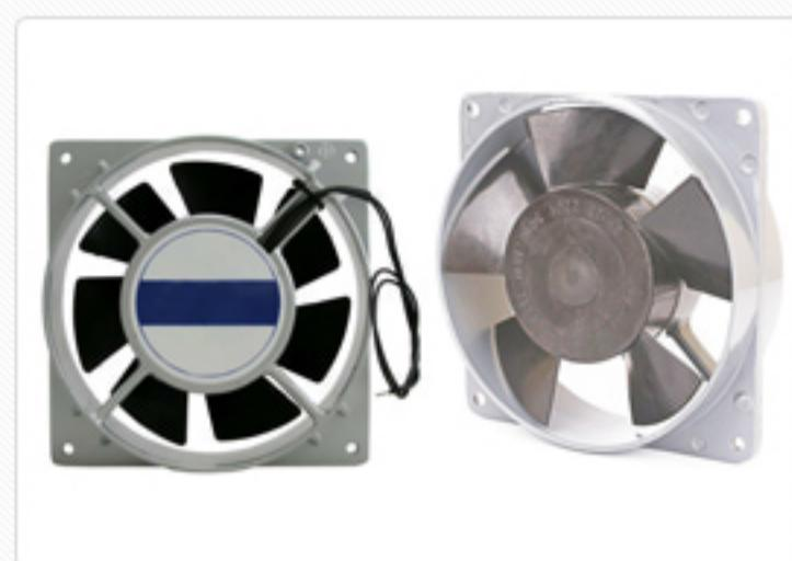
**Вентилятор ВН-2** – элемент системы приточной и вытяжной вентиляции, обеспечивающий терморегулирование устройств или помещений бытовой и промышленной деятельности. Вентиляторы рассчитаны на питание от сети переменного тока частотой 50Гц и напряжение **220В**, потребляемый ток при этом не превышает **100mA**, а потребляемая мощность – не более **22Вт**.
