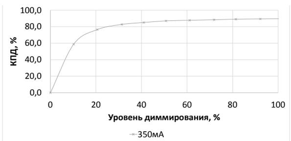
Все параметры измерены при напряжении питания 220В AC и номинальной нагрузке при 25° С окружающей среды.
