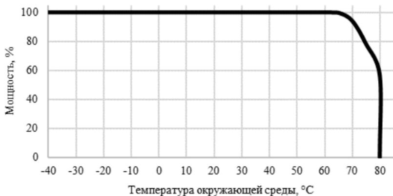
Зависимость мощности при максимальной нагрузке от температуры точки  $T_c$ .
