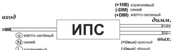
**ВНИМАНИЕ!** При параллельном соединении входов диммирования нескольких драйверов нельзя объединять выходы этих драйверов в параллель!
