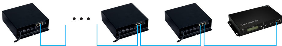
Рис 1. Все Slave-контроллеры подключаются к одному порту Master-контроллера.
