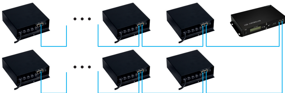
Рис 2. Slave-контроллеры подключаются к двум портам Master-контроллера.
